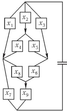
Рис. 22. Электрическая цепь, соответствующая замощению на рис. 21
