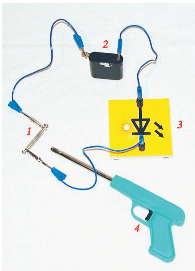
схему (см. рисунок) из когерера 1, батарейки 2 с ЭДС 4,5 В и светодиода 3, включенных последовательно. Сопротивление когерера сначала оказывается довольно большим, и светодиод не горит. Если искра зажигалки 4 возникнет на расстоянии не больше 20 см, то сопротивление когерера упадет, и светодиод загорится.
